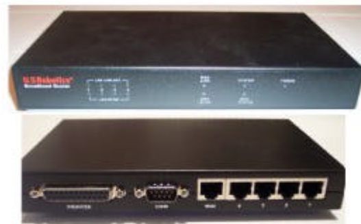
Router, aspecto delantero y posterior
