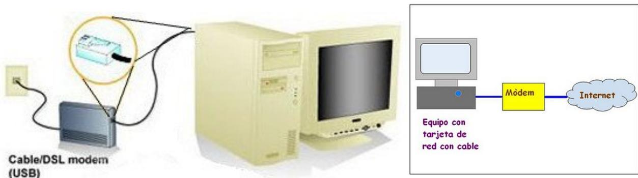
Fig 21: Conexión de un solo equipo con modem ADSL a Internet
