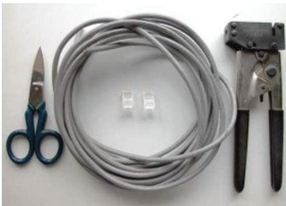
**Fig 16: Elementos para construir un cable UTP útil. Véase la crimpadora a la derecha**
