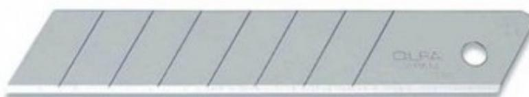
Dicha cuchilla está dividida en secciones, lo que permite partirla cuando el filo esté deteriorado, y aprovechar las secciones no desgastadas. Algunos cutter diseñados para fines particulares como cortar vidrio, usan hojas de doble filo. Los cutters cuentan también con un sistema para ajustar hasta qué punto la cuchilla sobresale de la agarradera.
