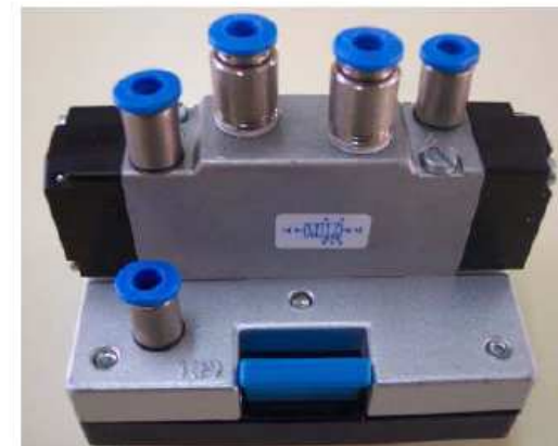
Foto de una válvula 5/2 activa y retorno por aire
